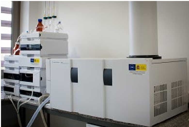
Cromatógrafo de líquidos de alta resolución acoplado a espectrómetro de masas con tiempo de vuelo de Agilent Technologies
