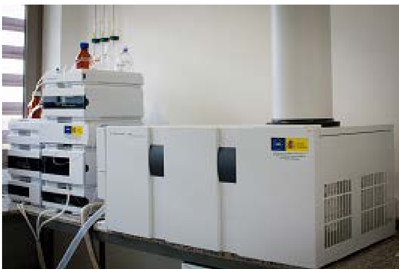
Cromatógrafo de gases acoplado a detector de masas triple cuadrupolo de BRUKER
