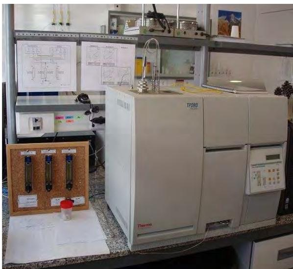
Se ha puesto en marcha y se encuentra totalmente operativo un **TPD/R/O 1100 de Thermo**. Dicho equipamiento permite la realización de desorción, reducción y oxidación a temperatura programada de compuestos sólidos para estudios de adsorción de moléculas sonda, estudio de grupos superficiales y comportamiento de sólidos frente a mezclas reactivas. Para permitir esta funcionalidad se ha realizado un montaje específico con tres
