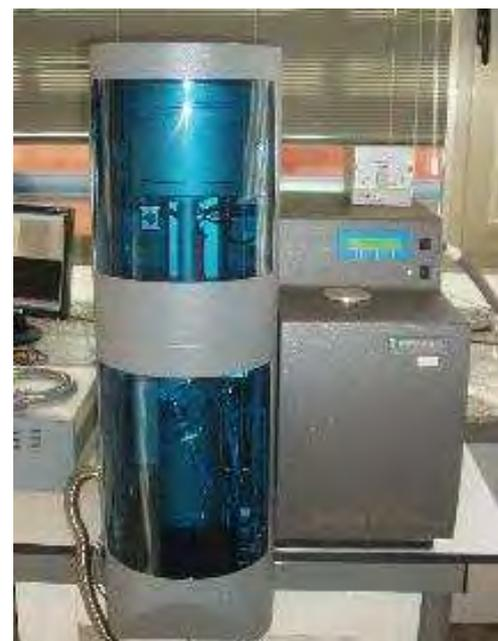
**Stereopycnometer** de Quantachrome específico para realizar medidas de densidad real en sólidos. Equipo totalmente operativo.
