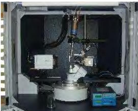
Por su parte el difractometro **Kappa Apex II** específico para análisis mediante difracción de rayos X de monocristales está totalmente operativo. Habiéndose adquirido material específico para el correcto montaje de cristales de muy pequeñas dimensiones, estando en fase de pruebas las metodologías de medida en este tipo de cristales.
