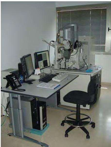
Se ha puesto en marcha y está totalmente operativo un nuevo **Microscopio Electrónico de barrido Dual Beam Quanta 3D FEG** de **FEI Company**, cuya versatilidad incluye modalidades de trabajo desde alto vacío a condiciones ambientales ESEM. Incorpora además, un cañón de iones para la realización de litografías y modelado de lamelas para TEM. Cuenta con detectores SE, BSE, EDX y FIB.
