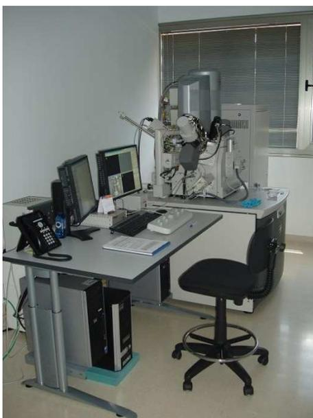
Está totalmente operativo el **Microscopio Electrónico de barrido Dual Beam Quanta 3D FEG de FEI Company**, cuya versatilidad incluye modalidades de trabajo desde alto vacío a condiciones ambientales ESEM; incorporando además un cañón de iones para la realización de litografías y modelado de lamelas para TEM. Cuenta con detectores SE, BSE, EDX y FIB.
