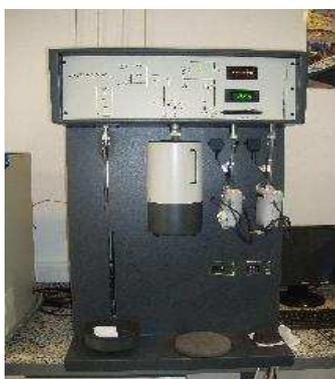
**Autosorb** de Quantachrome optimizado para metodologías de análisis basadas en la adsorción de nitrógeno; específico para estudio de meso y microporosidad de muestras. Se han optimizado métodos de medida de baja velocidad de adsorción para obtención de isothermas en muestras que presentan adsorción de He o Nitrógeno en las fases previas de desgasificación.
