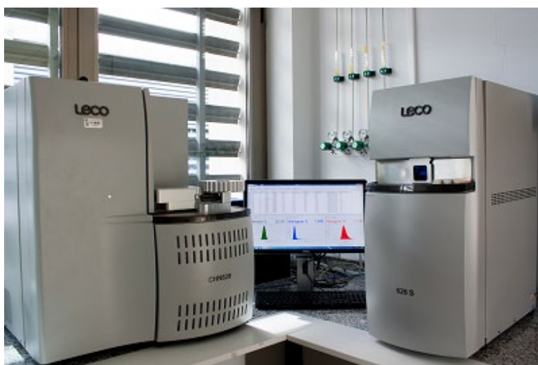
Macro-Analizador Elemental de LECO
