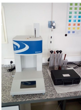
Indexador de Flujo Dynisco modelo LMFI-2NENNNN.
